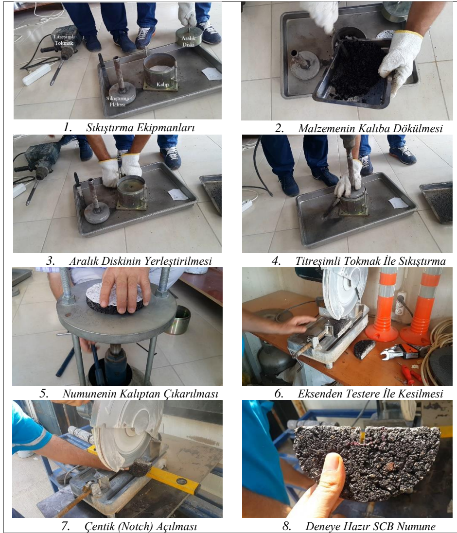
Şekil 2. SCB numune üretimi
