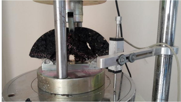
Şekil 4. Deney sonunda numunede oluşan deformasyon ve kırılmalar
