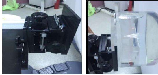
Şekil 1. BT Kalibrasyon ve KK İçin Kullanılan Fantom
