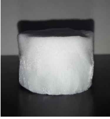
Şekil 3. STAB ajanı varlığında dondurarak şablonlama yöntemiyle üretilen modifiye edilmiş selüloz nanofibril köpük (STAB-SNF)
